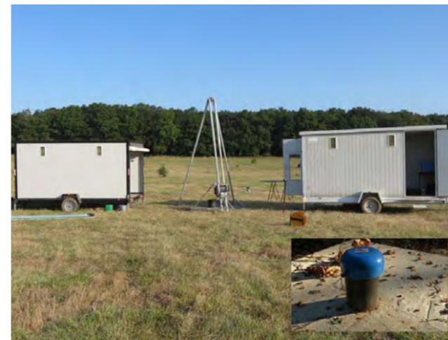
Les deux laboratoires mobiles et le trépied qui permet de faire descendre les sondes de diagraphies destinées au recueil des paramètres physiques via les forages.
