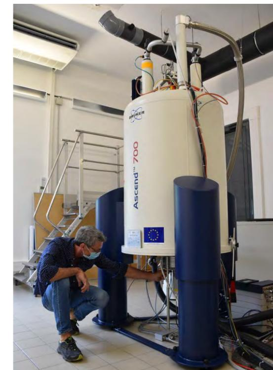
Spectromètre de Résonance Magnétique Nucléaire à 700MHz utilisé au CBM pour la détermination des structures tridimensionnelles de biomolécules, en particulier protéines.
