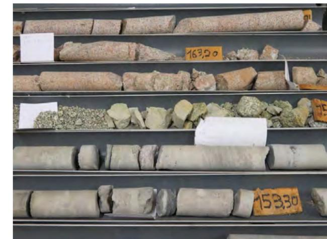
Les carottes extraites des forages sont recueillies et conservées à l'IC2MP depuis le début des expérimentations. De bas en haut sur le cliché, on peut observer à 153 m de profondeur les calcaires du jurassique supérieur, à 158 m du granite altéré, à 163 m le granite
