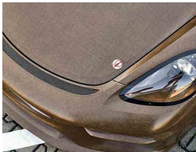
Exemple d'utilisation de matériau biocomposite à renfort lin dans l'industrie automobile
