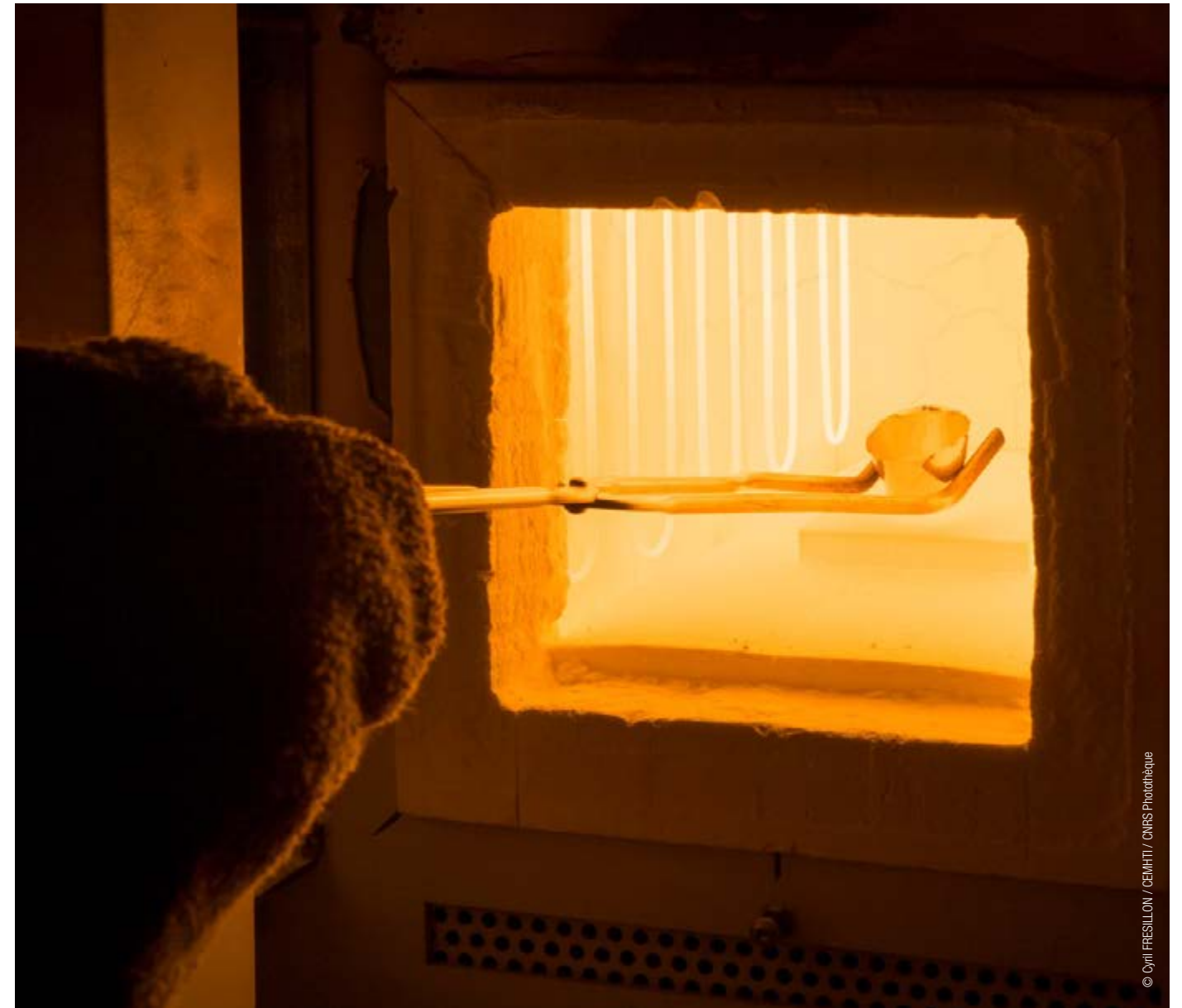
Opération de trempe de poudre céramique (1500°C).
