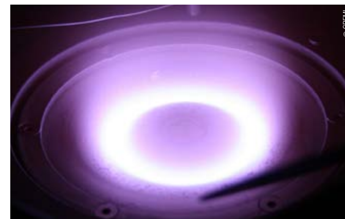
Plasma magnétron utilisé pour produire des nanomatériaux.
