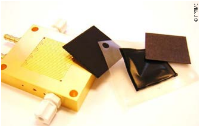
Exemple d'un assemblage membrane-électrode de pile à combustible à membrane échangeuse de protons (PEMFC) avec deux couches de diffusion et une plaque d'alimentation en gaz.
