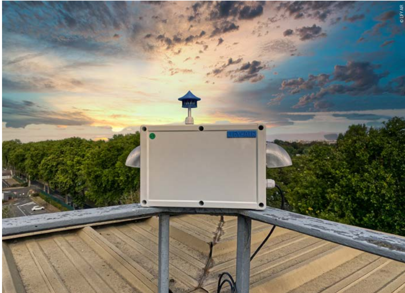
L'instrument Beenose de la société LIFY AIR pour la détection des pollens dans l'air ambiant.
