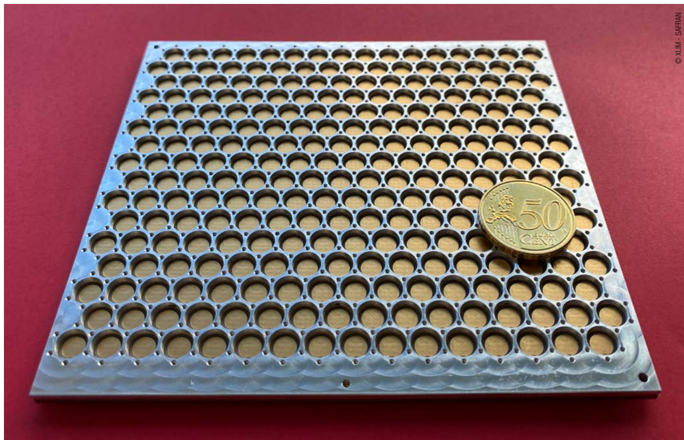
Vue d'une partie d'un réseau de 256 éléments rayonnants pour effectuer des dépointages de +/-70° en élévation.
