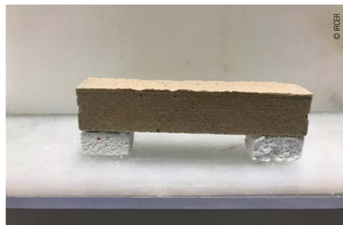
Aspect des échantillons 2x10cm 2 , d'une excellente tenue après un traitement à 1300°C
