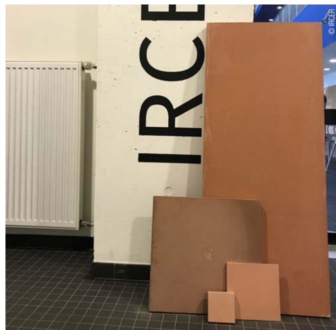
Différents volumes de pièces ont été élaborés. La pièce de 200 cm 3 au premier plan a été multipliée par 4, 50 et 120.
