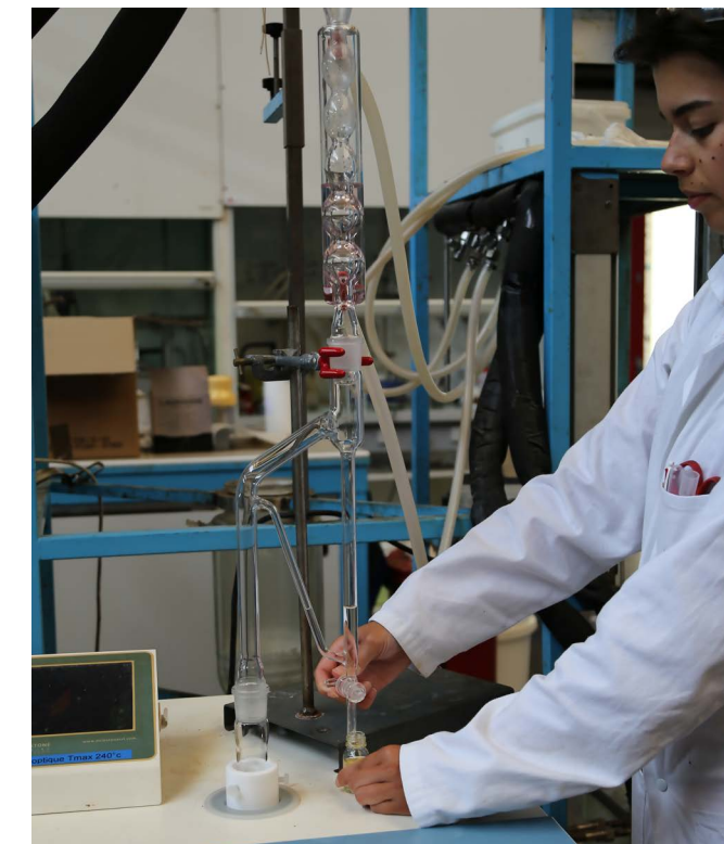
Hydrodistillation assistée par micro-ondes.
