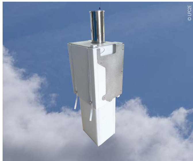
Nacelle de l'hygromètre conçu par le LPC2E.
