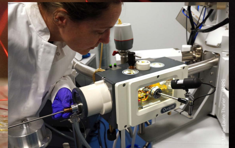
Chambre d'accueil d'échantillons du Microscope électronique à balayage (MEB) de la plateforme MACLE
