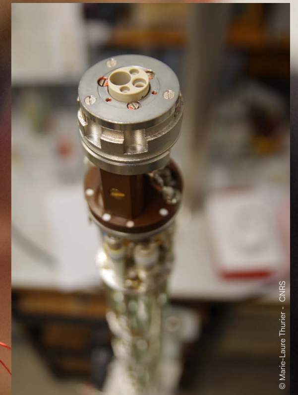
Sonde démontée utilisée pour la spectroscopie RMN in situ au laboratoire CEMHTI.
