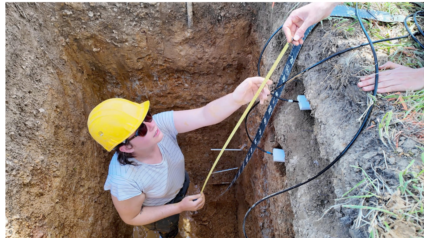
Installation de sondes dans une fosse pédologique pour suivre l'infiltration.
