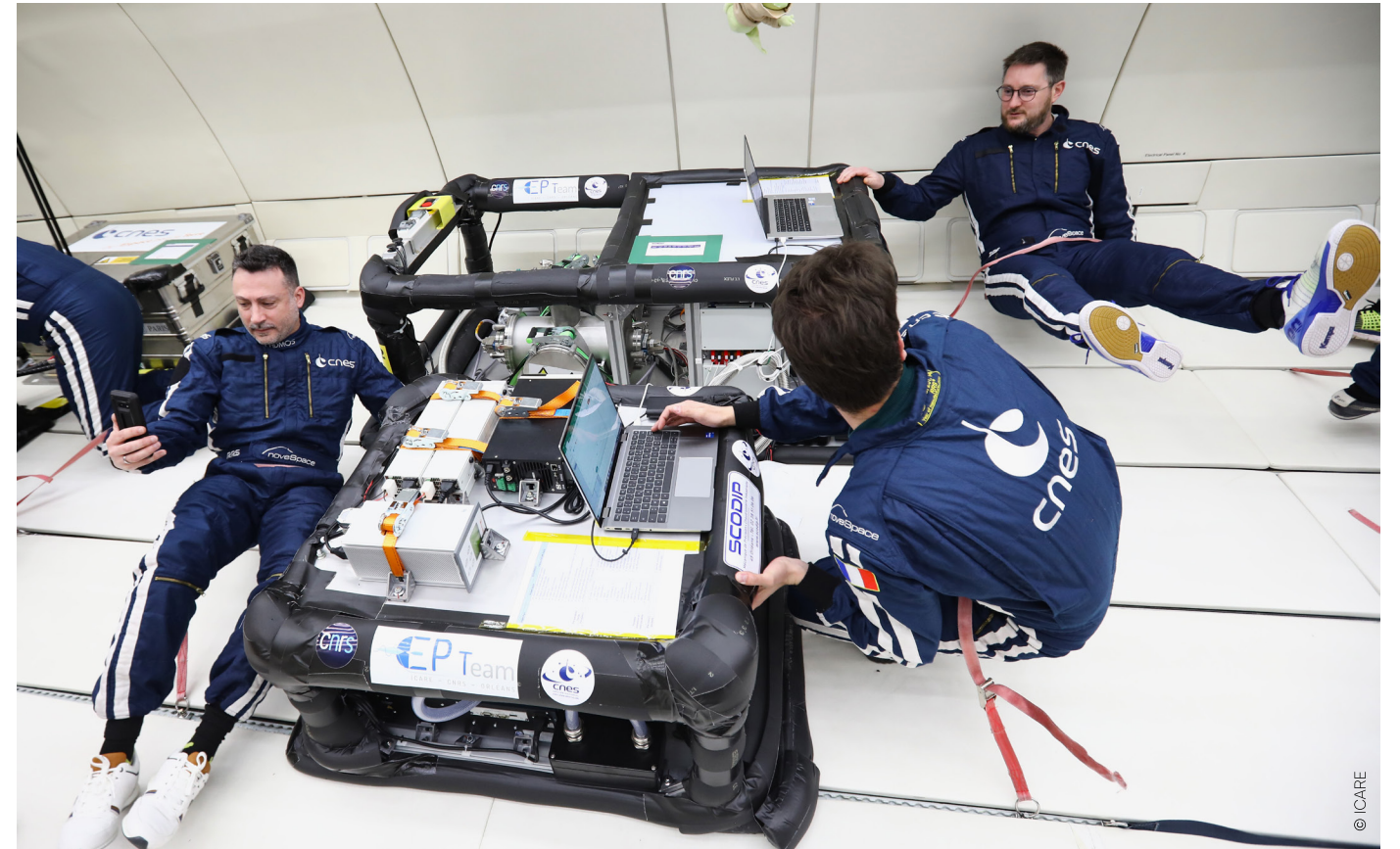
Expériences avec le propulseur résistojet à eau au sommet d'une parabole (état de micropesanteur). Le montage expérimental dédié fixé au plancher de l'avion et plusieurs membres de l'équipe d'ICARE réalisant des mesures en phase de « 0 g ».
