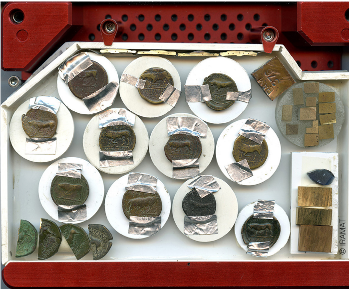
Monnaies en laiton à la légende Germanus Indutilli L(ibertus), environ 15 av. J.-C., installées pour leur analyse par LA-ICP-MS
