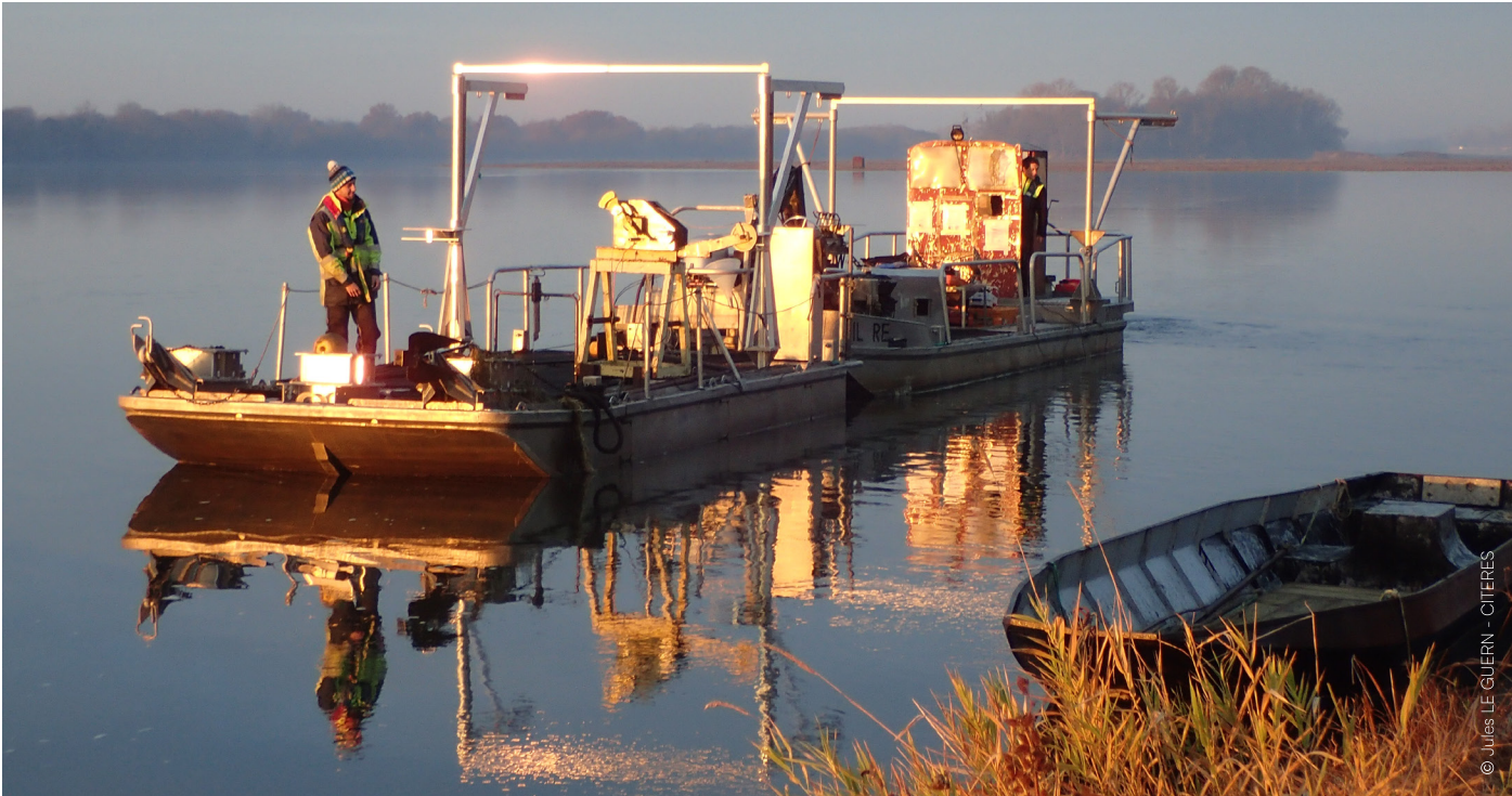
Barges pour le déploiement de la chaîne de mesure du transport solide sur les grands cours d’eau.
