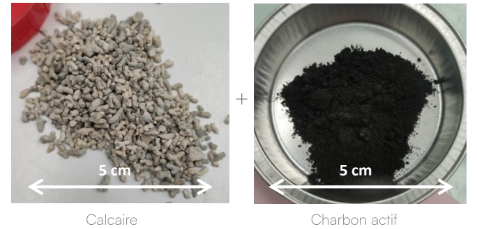
Matériau composite calcaire - charbon actif pour le traitement des eaux agressives
